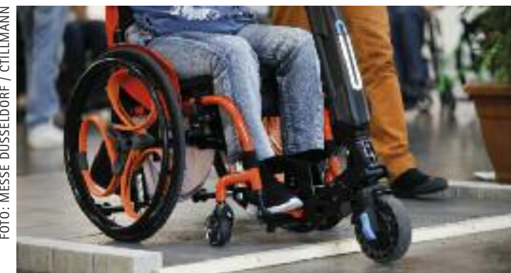
Gute Kombination: Der Elektroantrieb Blumil-GO zusammen mit den Loopwheels
